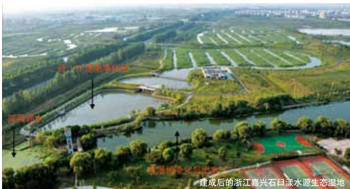
依托国家“水体污染控制与治理”重大科技专项研究成果建成的浙江嘉兴石臼漾水厂水源生物-生态修复湿地示范工程
