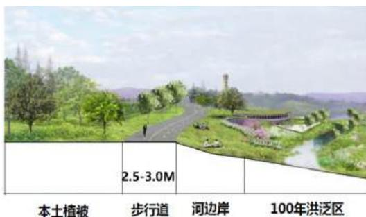
图 67: 步行通勤+游憩步道断面图
