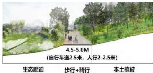
图 70: 主通勤绿道断面图
