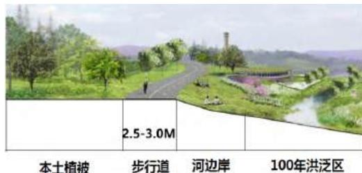
图 72: 步行通勤+游憩步道断面图
