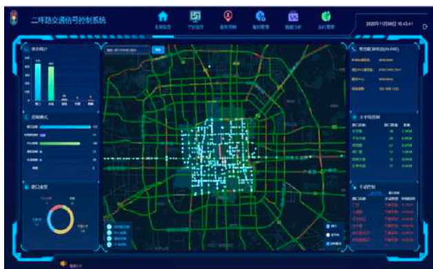
图 3-12 北京二环路交通信号控制系统界面 来源 北方工业大学城市道路交通智能控制技术北京市重点实验室供图
