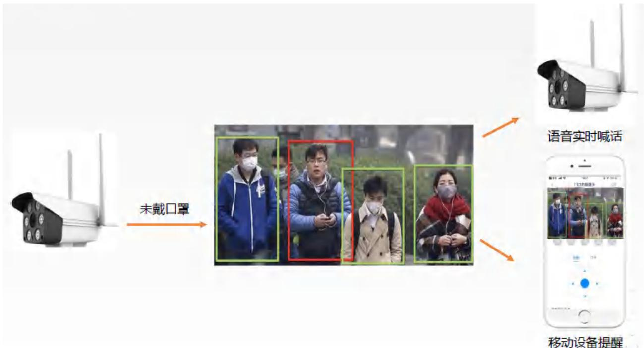
图 45 设备识别到未戴口罩人员的告警工作流程
