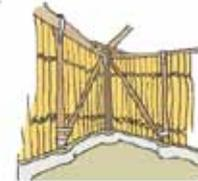
As paredes deste tipo de casas devem ser reforçadas com elementos diagonais e ancoradas firmemente no betão da fundação.
