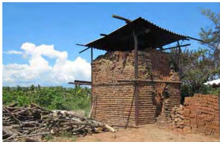
FIGURA 27: **Horno artesanal para quemar ladrillos.**
