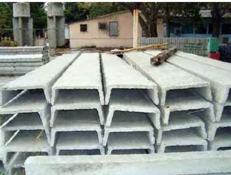
FIGURA 33: **Losa ferrocemento**
