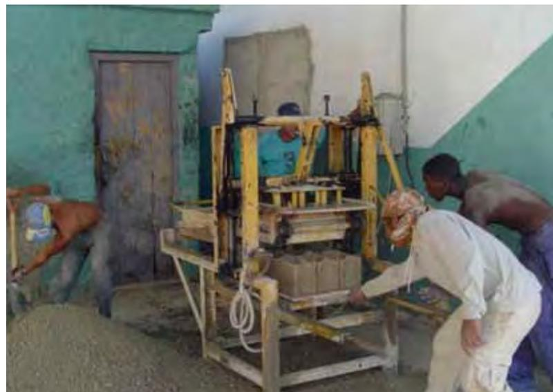
FIGURA 34: **Máquina Bloquera en la empresa municipal de Regla** (Foto: M. Bocalandro)
