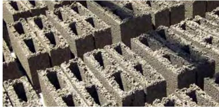
FIGURA 32: Bloques de cemento de 15 cm
